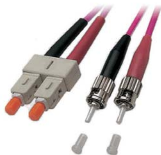
Latiguillo F.O. SC/ST 50/125 OM4 dúplex
