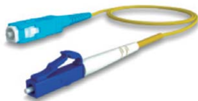
Latiguillo F.O. LC-UPC/SC-UPC 9/125 OS2 simplex
